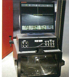
純正ハロゲンバルブ 画面数値の右側が明るさをカンデラ(cd)で示しており、1万5200cd。左上がりの緑の線がカットオフラインを示しており、車検で最も重要なポイントでもある。
