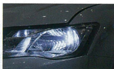
LEDヘッドランプバルブ (従来モデル) 明るさは2万6800cd。純正ハロゲンに比べて1.5倍以上の明るさで、配光特性もほぼ純正と変わらない。
